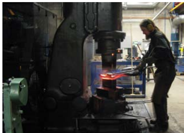
Här slår jag de första kraftfulla slagen i en lufthammare. Plåten deformeras och kränger runt av spänningarna i plåtens tjockare delar. Foto Pontus ersbacken
