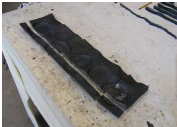
Först delar jag upp plåten i mindre delar så att den passar i kallbandsågen. Därefter kapar jag remsor i olika tjocklek.
